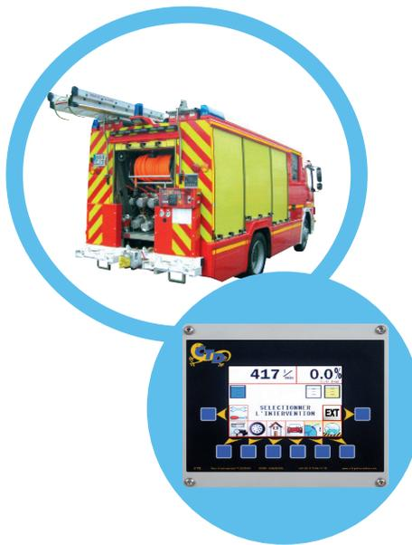
L'équipement indispensable pour les Pompiers, à installer sur camion. Le système peut utiliser 3 produits différents et à 6 concentrations d'emploi différentes préprogrammées. La Rolls contre les feux urbains.
