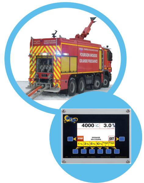
L'équipement de dernière génération pour les grands feux pétroliers et industriels. Il se positionne à distance du feu et dose l'émulseur d'une pression du doigt vers n'importe quel canon ou lance. Installé en fixe ou en mobile, il peut prendre l'émulseur de sources variées : réservoir fixe, citerne, remorque, container et fûts
