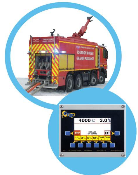
El equipo de ultima generación para los fuegos grandes de la industria petrolera y química. Se ubica a distancia segura del fuego y se inyecta la espuma con una presión del dedo hasta cualquier monitor o pitón. Se instala en un equipo fijo o móvil y puede utilizar el espumógeno de toda forma: cisterna, tanque, remolque, tambores
