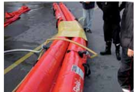
Unión entre dos longitudes y llenado de los dos tubos Connection between 2 sections and filling of the 2 tubes
