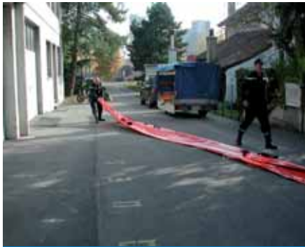
Despliegue de la Barrera Roll out of the boom
