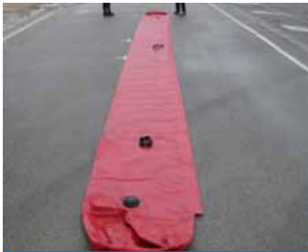
Desenrollamiento de la Barrera Roll out of the boom
