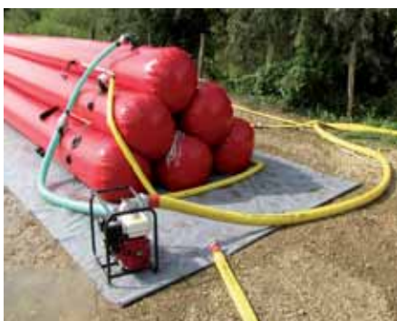
Vaciado de un tubo por medio de una Emptying of a tube with a pump
