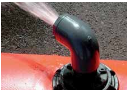
Llenado final cuando el agua sale de la válvula End of filling when water goes out the water pressure valve
