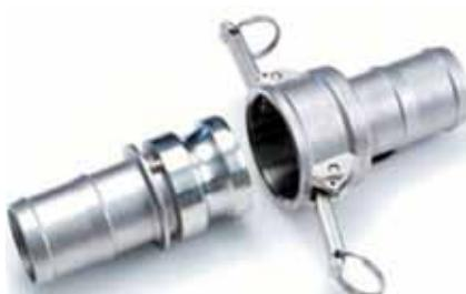
Le raccord à cames est un raccord rapide en aluminium ou polypropylène composé d'un embout mâle et d'un embout femelle. Pour raccorder, il suffit d'insérer la pièce mâle dans la pièce femelle, et d'abaisser les cames de la pièce femelle. Il est muni d'un joint pour une étanchéité parfaite et est disponible dans plusieurs diamètres. Il est très résistant et rapide d'utilisation.
