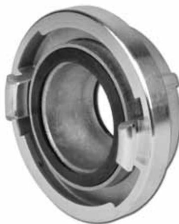
Le raccord Storz est un raccord rapide en aluminium ou polypropylène particulièrement utilisé dans les pays tels que la Suisse, l'Allemagne et en Europe de l'Est notamment. Il possède deux guides qui se placent chacun dans les rainures d'un second raccord identique. Une rotation d'un demi-tour permet de sérer les deux raccords.
