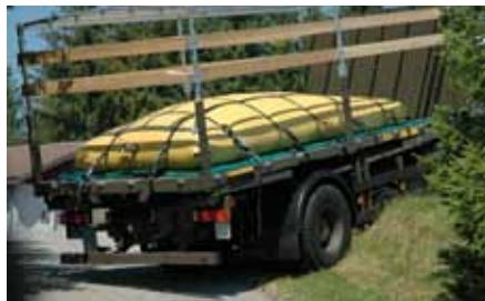
Les citernes souples transportables sont conçues pour l'acheminement de l'eau dans des endroits difficiles, avec un maximum de sécurité grâce aux parois internes et aux harnais de maintien.
