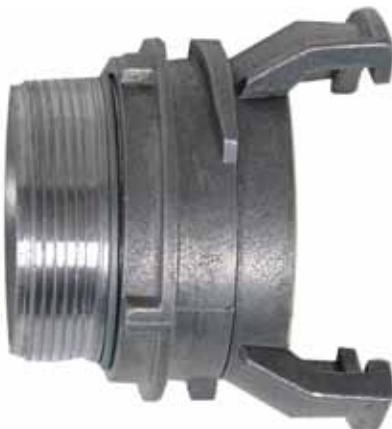
Aussi appelé « Raccord Guillemin » ou « Raccord Pompier », le ½ raccord symétrique est un raccord rapide en aluminium ou polypropylène simple à utiliser. La connexion s'établit en faisant coulisser le verrou d'un raccord dans les « oreilles » du raccord opposé. Muni d'un verrou et d'un joint pour une étanchéité parfaite, il est disponible du DN 20 au DN 100. Disponible sous différentes formes : à visser, cannelé, avec verrou, avec bouchon,etc.
