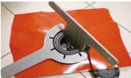
Pour la manipulation des valves Monsun, RCY propose un kit de serrage/desserrage, composé d'une clé de serrage et d'une clé de desserrage. Le kit permet périodiquement de resserrer les valves qui auraient pu se desserrer avec le temps. Le kit sert aussi pour le remplacement de valves.
