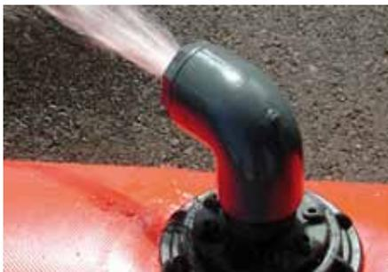
Fin du remplissage lorsque l'eau sort de la soupape
