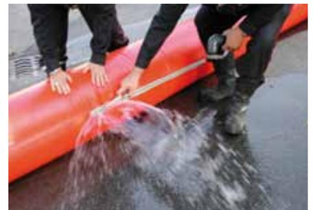
Ouverture de la fermeture éclair une fois que le barrage n'est plus sous pression / Zip opening once the boom is no more under pressure
