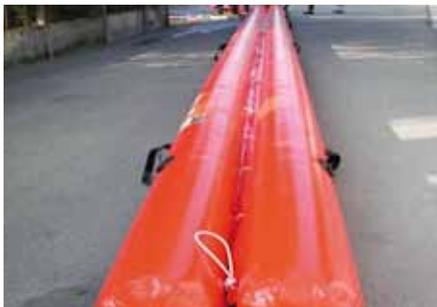
Les 2 tubes doivent être bien serrés avant de recevoir le monotube
