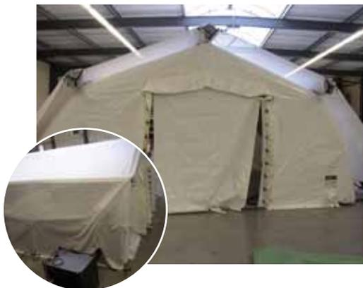
Le pare-soleil recouvre la tente (toit + mur) afin de réaliser un ombrage, supprimant ainsi les phénomènes thermiques solaires (effet de serre, rayonnement). Fabriqué en PVC, il est constitué de trois boudins gonflables glissés dans des fourreaux permettant de réaliser une lame d'air entre le pare-soleil et la tente. La fixation au sol est assurée par des sangles d'arrimage réparties sur les deux longs pans ainsi que par des points d'attache pour hauban au niveau des pignons.
