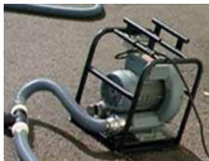
Pour la mise en œuvre de ses tentes gonflables, RCY propose un gonfleur électrique à pieuvres. Il est particulièrement adapté pour réaliser le gonflage et le dégonflage rapide des arches de tentes.
