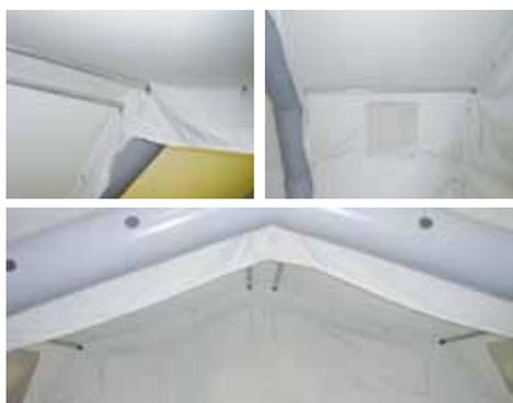
Le Vélum permet de créer une lame d'air de 20 cm sous l'entoilage à l'intérieur de la tente. Cette lame d'air assure une fonction d'isolation thermique. Il est constitué de plusieurs entoilages fabriqués dans le même tissu que celui servant à la fabrication de l'entoilage. Ces divers entoilages viennent se fixer sur les passe-fils soudés, à l'aide de crochets S, sur les arches gonflables de la tente.
